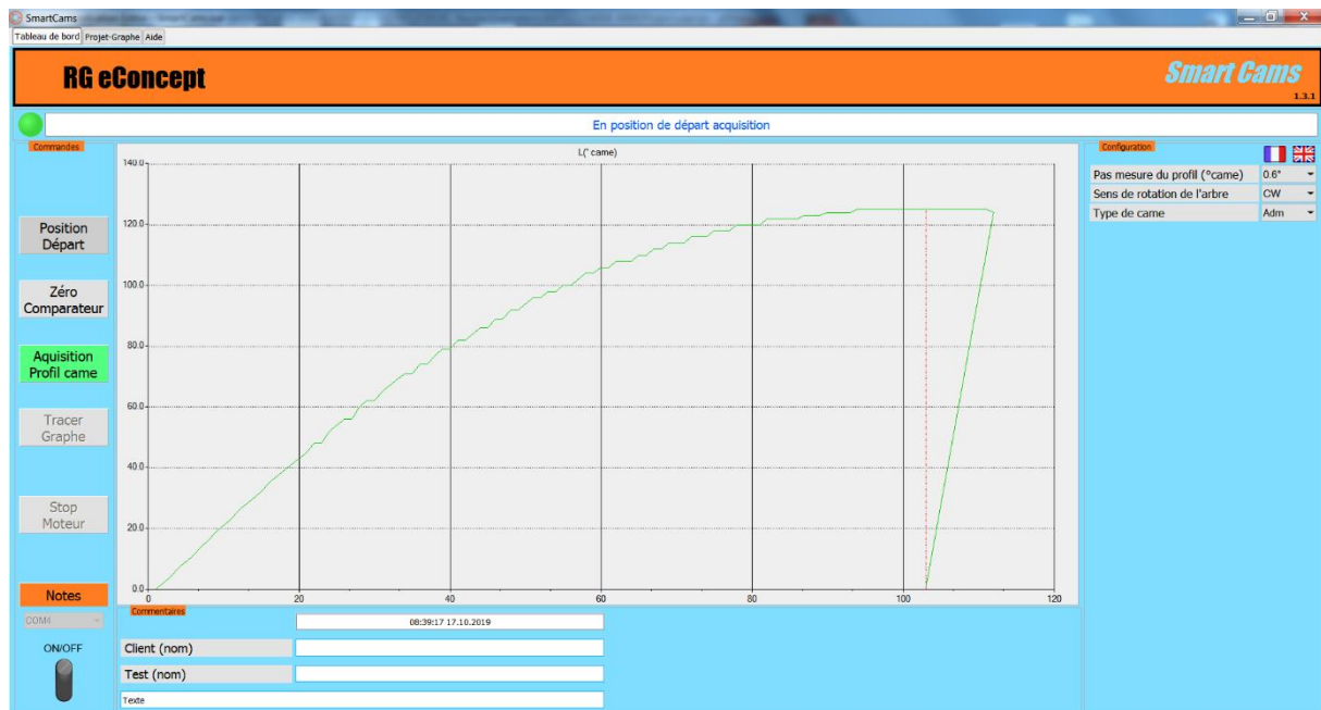
Figure 9 Détermination du "max lobe" et positionnement pour le début de l'acquisition du profil complet
