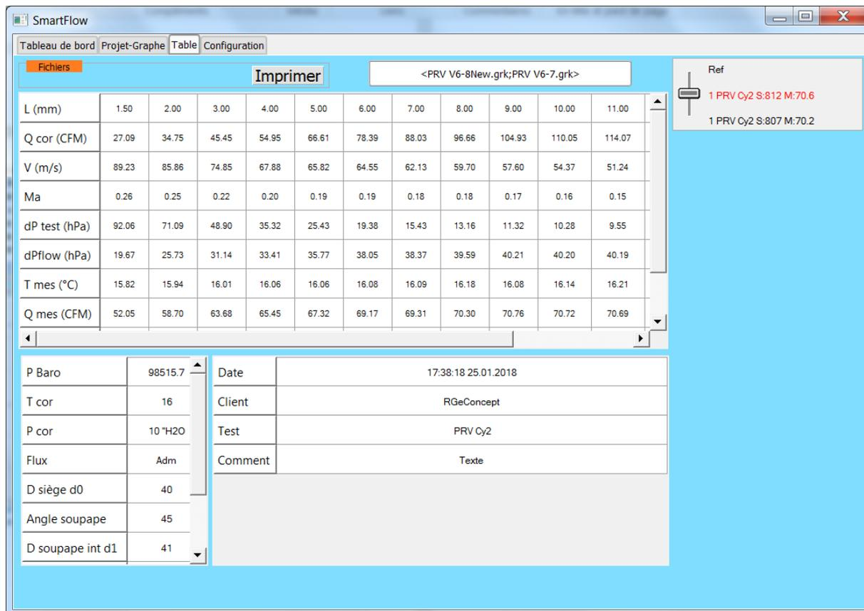
Figure 18 Lecture d'une table d'un projet à 2 courbes. Sélection/visualisation de la 1ere.
