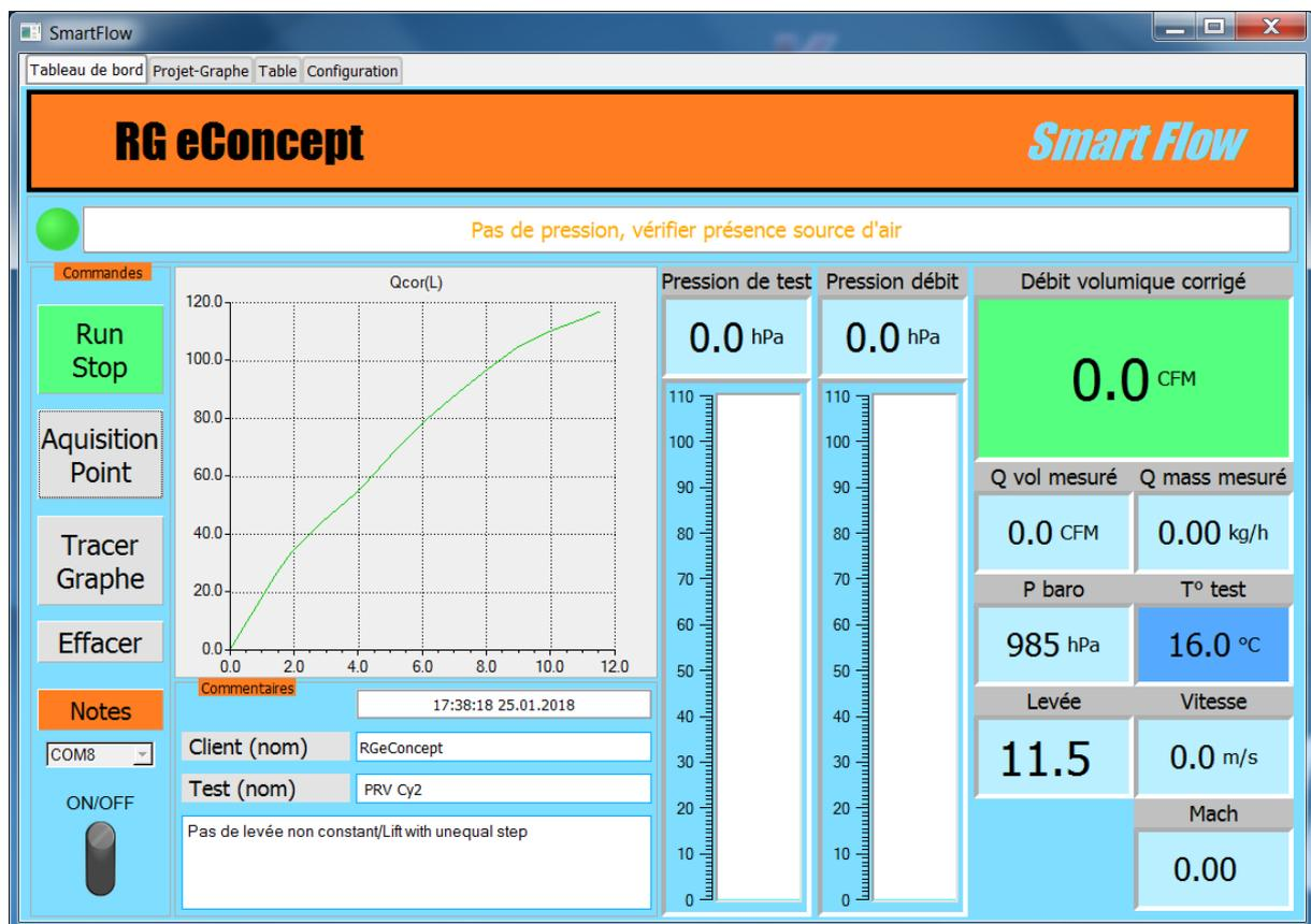
Figure 13 Fin d'acquisition : levée max atteinte et graphe temps réel complet.
